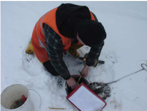
Foto: Messung des Grundwasserstands (ERDWÄRME21 GmbH)
