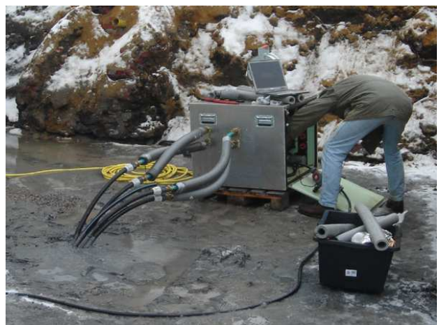
Foto: Thermal Response Test (ERDWÄRME21 GmbH)
