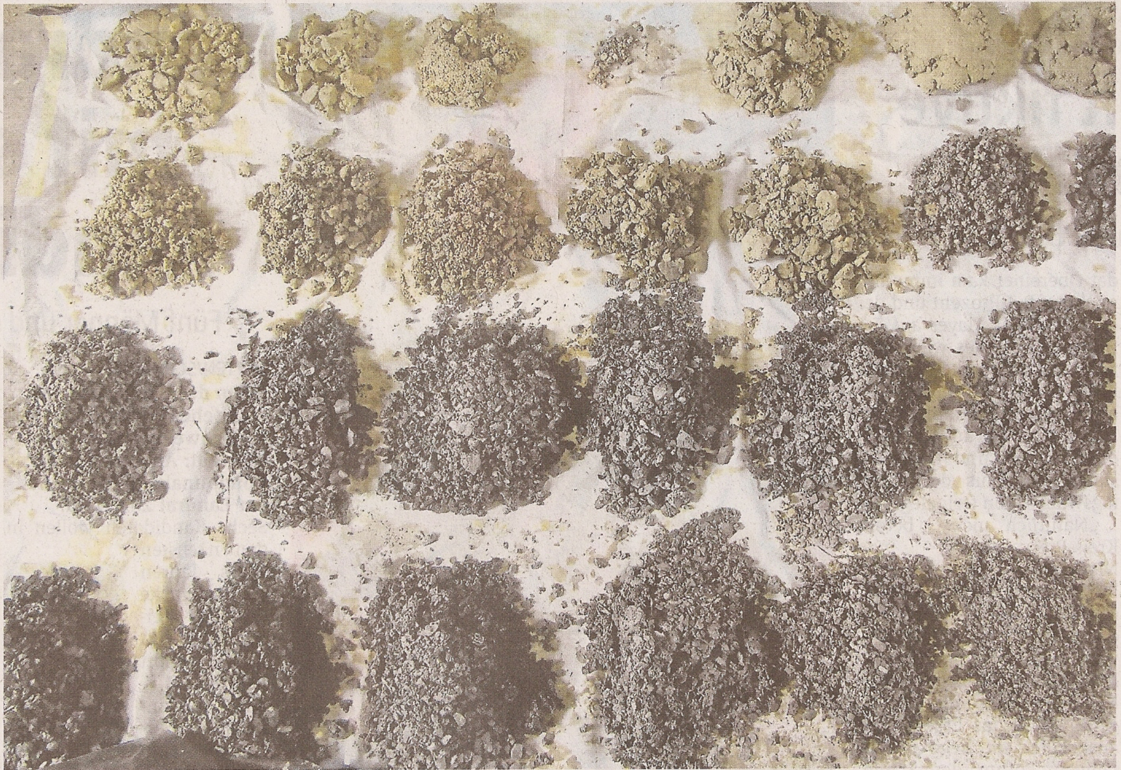
Erdproben aus dem Bohrloch: Die Farbe wird immer dunkler, denn die oberen Schichten sind bräunlich und lehmhaltig, wechseln zunächst ins Grau der Tonschicht und werden dann steinig und dunkel.
