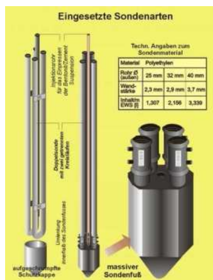
Abbildung 4: Erdwärmesonde
